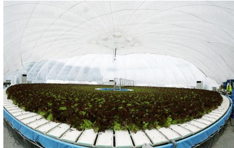
Поворотный механизм в бассейне купольных теплиц японской Granpa Co.,Ltd. сложный и дорогой, а надувной (D27m) купол не рассчитан на нашу снеговую нагрузку. Цена комплекта 325тысяч евро + таможня + доставка + монтаж + программное обеспечение.
